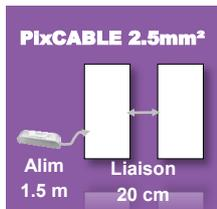
Les connecteurs permettent de raccorder un panneau PixBOARD™ à un autre (PixCABLE™ liaison) ou au transformateur (PixCABLE™ Alim).
