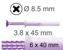
Fixation sur cloison sèche et corps creux au moyen de la visserie **PixANCHOR™**.
